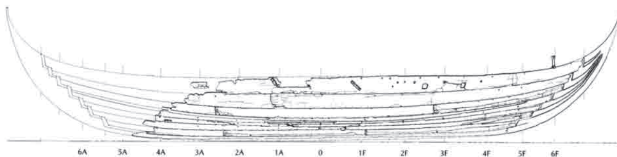
Il. 1. Sylwetka wraku łodzi Skuldelev 3 z początków XI wieku, interpretowanej jako jednostka typu szkuta (wg O. Crumlina-Pedersena 2002)
