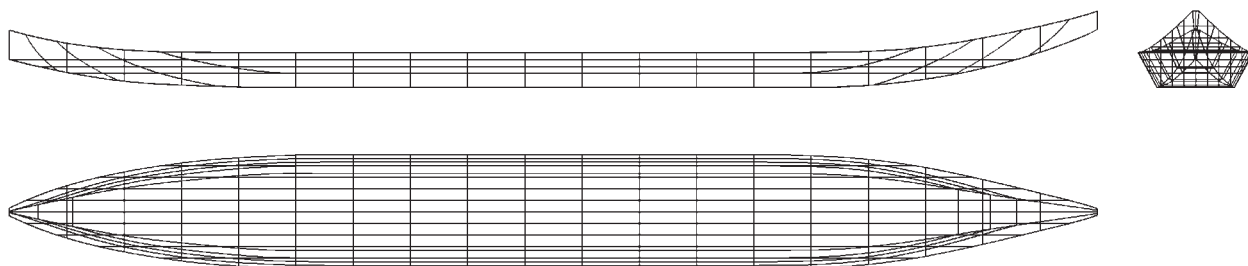
Rys. 42. Linie teoretyczne zrekonstruowanego kadłuba wraku z Krosna Odrzańskiego
